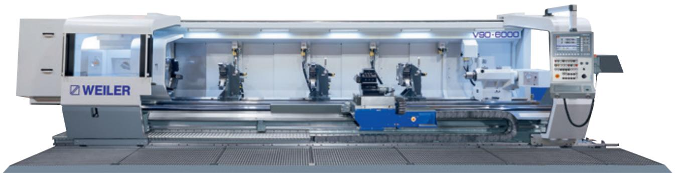
4-Bahnen-Präzisionsdrehmaschinen mit Zyklenautomatik
