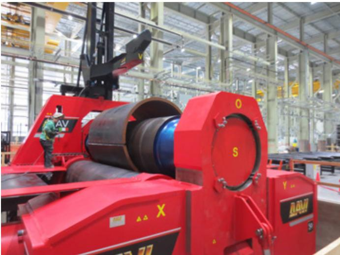
3-Walzen Rundbiegemaschinen MAV-Modell mit variablen Achsen für Dickblechverarbeitung
