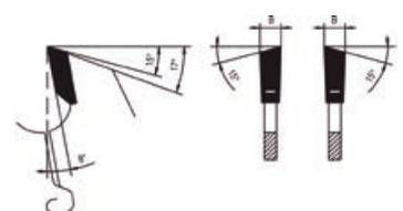
**GUHDO®****HW-Standard-Wechselzahn-Kreissägeblatt - Verzahnung mittel**
