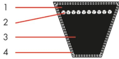
1 Gummiauflage; 2 Zugstrang; 3 Gummikern; 4 imprägnierte Gewebeamantlung
