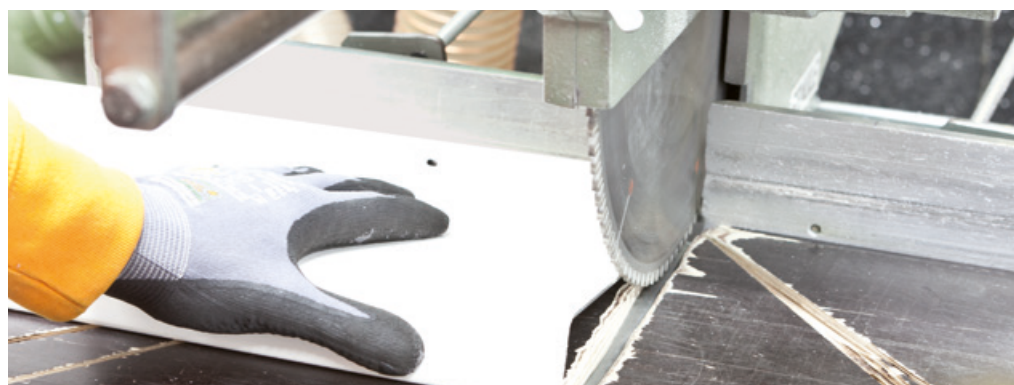
Längsschnitt auf das gewünschte Maß
