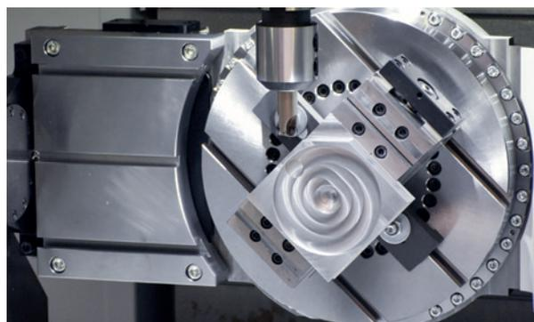
Durch den Dreh/Kipp-Tisch kann man Werkstücke bis zu einem Durchmesser von 350 mm hochgenau bearbeiten.
