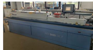
BJ 11, Kantenanleimmaschine mit Fügefräse (inkl. DIA-Werkzeug), Werkstück für Kantenmaterial bis 3 mm, 8 - 60 mm Werkstückdicke ohne Fügeaggregat, 8 - 40 mm mit Fügen, SPS-Steuerung (inkl. Touchscreen), Freiplätze für
