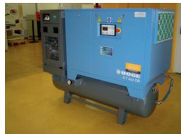
Schraubenkompressor incl. Kältetrockner und Druckluftkessel, Mikroprozessor-Steuerung „base control“, Betriebsspannung Kompressor 400 V/50 Hz – Trockner 230 V / 50 Hz, Netzdrucksensor, riemengetriebenes Antriebssystem, niedrige Drucklufttemperatur durch wirksamen Nachkühler, liegend untergebauter Druckluftbehälter, gestrahlt, lackiert in basaltgrau RAL 7012 mit 250 Liter, Kondensat-Ablasshahn, Kälte-Drucklufttrockner arbeitet automatisch
