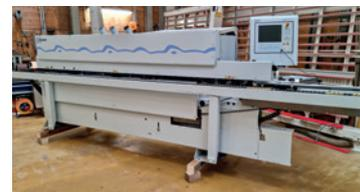
BJ 2015, Aggregatebestückung: Fügefräsaggregat, Kopieraggregat, Ziehklingenaggregat, Schwabbelaggregat, Kappsägeaggregat, 11 m/min Vorschub, min. 70 mm Werkstückbreite, max. 8 mm Anleimerdicke, max. 65 mm Anleimerhöhe, max. 3 mm Dicke Rollenmaterial, 8-60 mm Werkstückdicke, 0,4-8 mm Kantenmaterialstärke. VK: € 36.900,00 exkl. USt.
