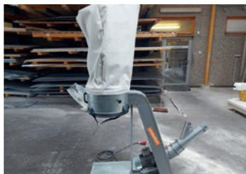
BJ 2011, 2,2 kW schallgedämpfte Ausführung, 400 V, 50 Hz, 160 mm Saugstutzen, Volumenstrom 2170 m³/h Pressung, P ges: 2036 Pa. VK: € 890,00 exkl. USt.
