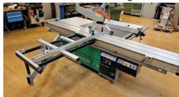
BJ 95, 5,5 kW, 3.200 mm Schlittlängle, 1050 mm Schnittbreite, digitale Drehzahlanzeige, 2 Achs Vorritzer elektrisch verstellbar, digitale Anzeige Schwenkung, CE-Ausführung, Parallelschutzvorrichtung, automatische Bremse, Tischplattenverlängerung 800 mm, Verriegelung Doppelrollwagen. Preisstellung im überholten Zustand - 6 Monate Gewährleistung! VK: € 10.800,00 exkl. USt.
