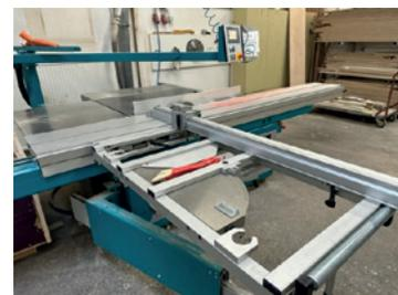
Formatkreissäge mit beidseitig schwenkbarem Sägeblatt
