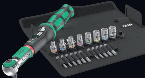
1 Safe-Torque A 2 Drehmomentschlüssel mit 1/4"-Sechskantantrieb, Messbereich 2-12 Nm; für kontrollierten Rechts- und Linksanzug; Anziehen und Lösen mit und ohne Drehmoment, ausschaltbare Drehmomentfunktion (Torque Lock Funktion).
