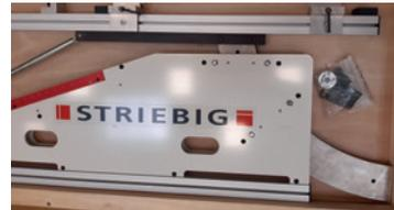
WSG 025.820, Das WSG Winkelschnittgerät hält das einmal eingestellte Maß in allen Winkelseinstellungen exakt. Es ist auf allen Striebig-Modellen einsetzbar und kann an allen Schnittpunkten montiert werden. Eine spiegelverkehrte Montage (rechts vom Schnittpunkt) ist ebenfalls möglich.
