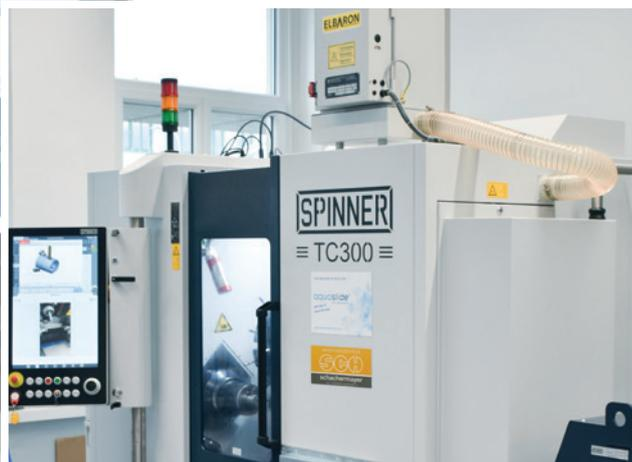
Die künftigen Flugzeugtechniker lernen das CNC-Drehen auf einer Zweispindel-Universalrehmaschine.
