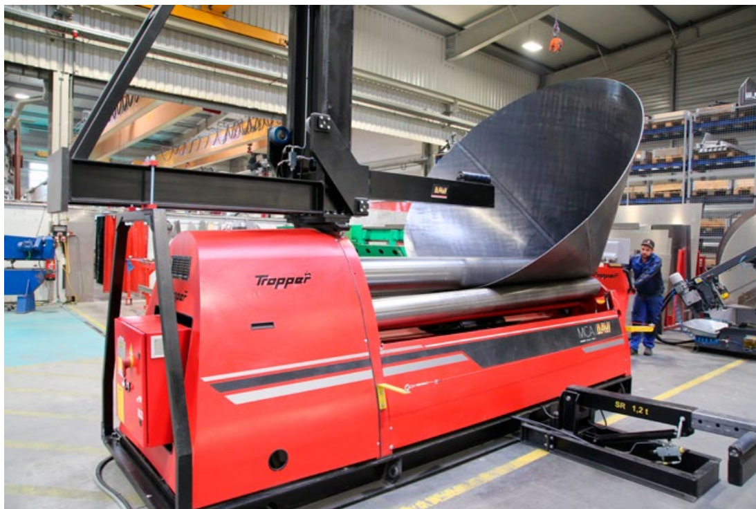
Für das Einrollen von Blechen setzt Tropper auf Vier-Walzen-Rundbiegemaschinen der MCA-Baureihe von Davi.
