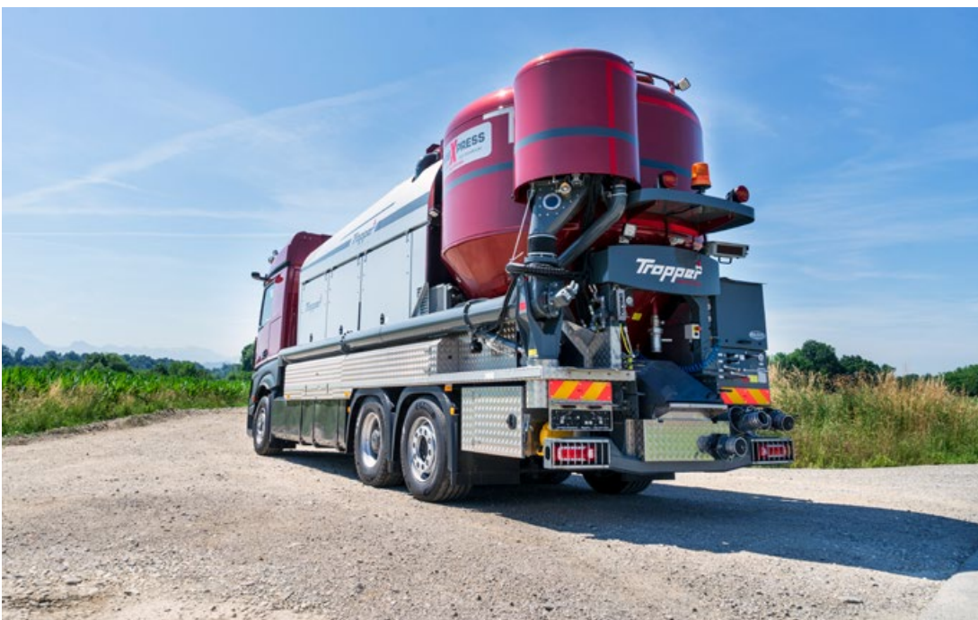
Fahrbare Tropper-Anlage MMX mit Sechs-Tonnen-Mischer und Austragschnecke zur Erzeugung von Tierfutter am Bauernhof.
