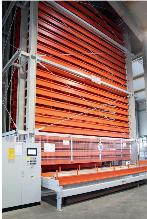
**Der neue Kasto-Lagerturm** sorgt beim Rohrlaserschneiden für optimalen Materialfluss.
