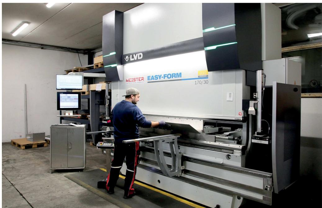
Die LVD-Werkzeuge mit progressivem Stone-Radius vermindern aufgrund eines gleichmäßigen Gleitens des Materials in die Matrize Kantspuren am Werkstück.
