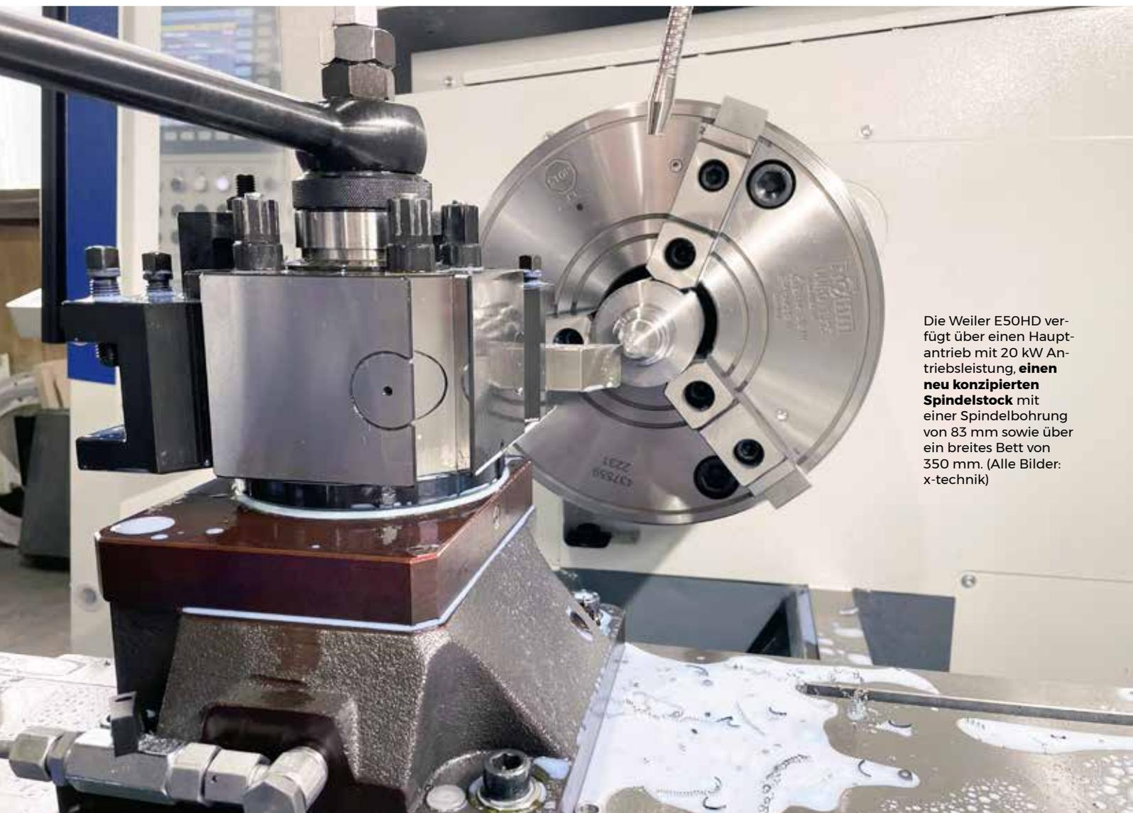
Die Weiler E50HD verfügt über einen Hauptantrieb mit 20 kW Antriebsleistung, **einen neu konzipierten Spindelstock** mit einer Spindelbohrung von 83 mm sowie über ein breites Bett von 350 mm. (Alle Bilder: x-technik)
