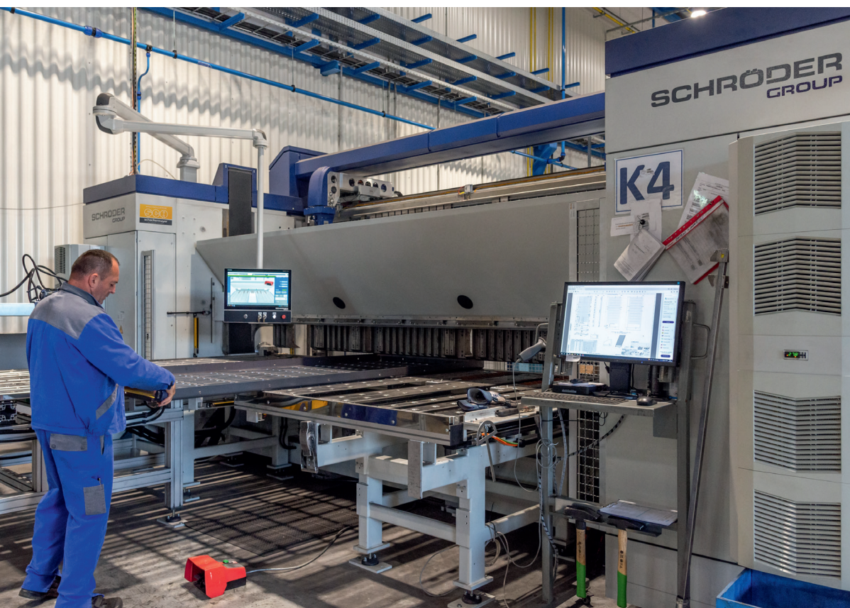
Die MAK4 Evolution UD von Schröder biegt bei Scheuch bis zu 5 mm starke Stahlbleche auf 4.000 mm Breite überaus präzise.
