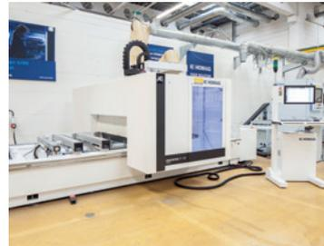
K-Tisch LED "M" (LED-Positionierung), Future 10 kW, Werkzeuglängenvermessung, manueller Anschlag Deckschicht - 6St., 1x Vakuumpumpe (63 m³/h), Kabelgebundene Handbedienung, USV, Komfort-Bedienung, WoodWOP, 3D Simulation, Maschinendaten erfassen und auswerten MMR, Lamello P-System, Barcode Basic inkl. Handschuhscanner, WoodWOP Professional inkl. DXF import, 3D Simulation.
