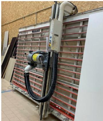
BJ 03, 5,5 kW, Schnittbereich: 4300 x 2200 (2100 xHhor) x 80 x 80 mm, 303 mm Sägeblatt-Ø, 4750 U/min Sägeblatt-Drehzahl, 3x400 V/50 Hz Netzanschluss, LxHxT 1x12 6451 x 2901 x 1661 mm, Preisstellung im überholten Zustand – 6 Monate Gewährleistung.
