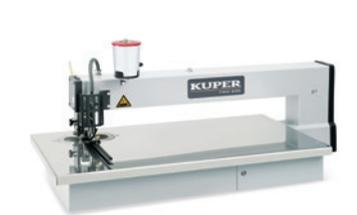
Der von einem beheizten Fadenführer in Zick-Zack-Linie aufgetragene KUPER-Leimfaden garantiert eine dichte und feste Fugenverbindung. Die Fadenseite wird beim Verpressen nach innen gelegt. Dadurch entfällt das lästige Abschleifen des Klebmediums. Spezifische Merkmale: Diskusscheibensystem mit Toleranzausgleich für unterschiedliche Furnierdicken, Niosta-Arbeits-tisch, hart verchromte Druckrolle, 8-Stufen-schalter zur Regulierung der Heizleistung, Start-/ Stop-Fußschalter.
