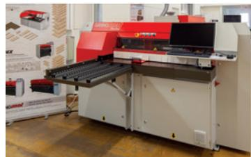
Kompletter Werkzeug- und Bohrsersatz, Fräsaggregat Profi t HSK63F mit 3-fach Magazin, Rollentisch 765 mm (Y-Achse), klappbar, für Maschinenvorder- und Rückseite, B 500 mm, Hilfsanschlag 600 mm mit integrierten Rollen, Gegendruckeinrichtung von Oben, Absaugverteiler Ø 160 mm / Ø 80-80-80 mm, Raster 196 mm, Maschinen-Innenraumbeleuchtung über LED's.
