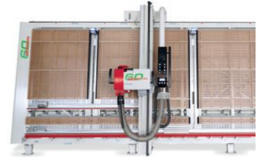
Plattenabsenkvorrichtung PAV (3.PA-Einheit), Vorritz-Sägeaggregat VSA (stufenlos), Spannflansch ProLock, Kleinteileauflage aus Aluminium (2 Elemente), Set für freistehende Montage.
