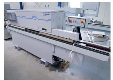
BJ 08, Fügefräsaggregat / Anleimen / Kappsägeaggregat 2 Motoren / Bündig-Radius-Fasestation / Profil und Flachziehklingenaggregat, Streifenmagazin, max. 3 mm Anleimerdicke, Steuerung BRANDT BFS, max 55 mm Anleimerhöhe, max. 11 m/min. Vorschub, Leimsystem Granulat Leimbecken unten, Schnellwechsel-Leimbecken, 10 kW Gesamtanschluss, 3.570 mm Maschinenlänge, Preisstellung im überholten Zustand – 6 Monate Gewährleistung!
