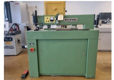
BJ 91, ca. 0,4 - 2 mm Furnierdicke, ca. 15m/min Vorschub, 0,18 kW Antriebsmotor, 0,5 kW Gesamtanschluss, LxBxH 1280 x 580 x 1470 mm, 166 kg. Preisstellung im überholten Zustand - 6 Monate Gewährleistung.
