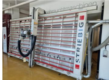
BJ 06, Alu-Lattenrost, 4300 x 2240 (2100 xHhor) x 80 mm Schnittbereich, 5,5 kW Sägemotorleistung, 300 mm Sägeblatt-Ø, 4750 U/min Sägeblatt-Drehzahl, 3x 400 V/50Hz Netzanschluss, LxHxT 1x12: 5620 x 2893 x 1695 mm. Preisstellung im überholten Zustand - 6 Monate Gewährleistung.
