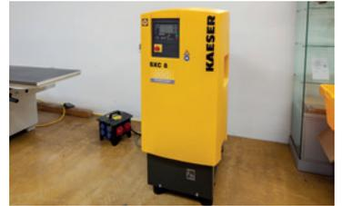
Schraubenkompressor mit angebaute Kältetrockner und Druckluftbehälter, max. 11 bar, 0,67 min/m³, 215 l Behältervolumen, 69 dB (A).
