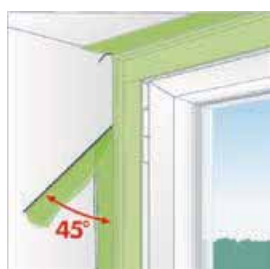
Bild 1: Überstehende Folie mit dem Reißfaden unter 45° abreißen.
