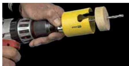
Einfaches Entfernen des Sägekerns
