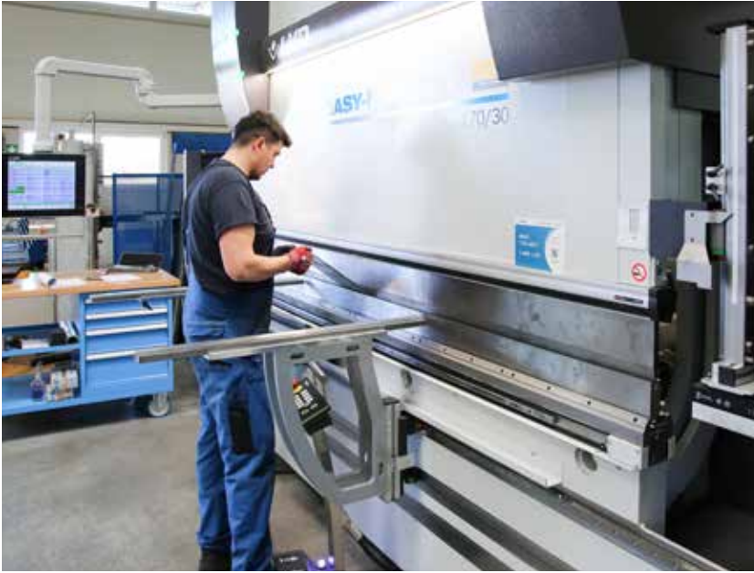
Das adaptive EFL-Biegesystem garantiert den gewünschten Winkel vom ersten Biegevorgang an. Schwankungen in der Blechstärke, Festigkeit oder im Körnungsverlauf werden automatisch kompensiert.
