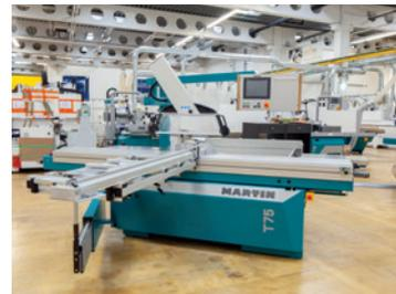
7,5 kW (10 PS) stufenlos, 3,3 m Besäumlängslänge, 1350 mm Schnittbreite, Elektr. motor. Pos. Parallelschlags, 3-Achsen – Vorritzaggregat, Vorritzer-Beleuchtung Safe Light, Parallelogramm-quertisch, Längenanschlag digital.
