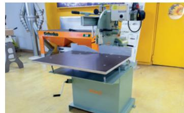
5 kW, hydraulische Umkehr-Vorschubbremse, Maschine über Handrad von vorn neigbar, HM-Kreissägeblatt für Holz 520 x 4,0 x 50 mm / Z 60 / WZ-neg.
