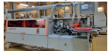
BJ 2011, Aggregate: Fügen, Anleimen, Kappen, Fräsen, Eckenkopieren, Radiusziehklinge, Flächenziehklinge, max. 3 mm Anleimerstärke, min. 6 / max. 45 mm Werkstückdicke, min. 65 mm Werkstückbreitemin. 160 mm Werkstücklänge/ bzw. 250 mm (beim Eckenkopieren), 10 m/min. Vorschubgeschwindigkeit, 6 bar Druckluftanschluss, min. 254,00 lt/min., 4850 x 1090 x 1900 mm, ca. 945 kg, Preisstellung im überholten Zustand - 6 Monate Gewährleistung!
