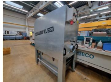
BJ 08, Reinluftabsauggerät, 200 mm Absauganschluss-Ø, <0,1 mg/m³ Reststaubgehalt, max. 4000 m³/h Volumenstrom, 2300 m³/h Nennvolumenstrom (20 m/s), 20 m² Filterfläche, 2380 Pa Unterdruck, 2 x 200 l Spänefangbehälter, Preisstellung im überholten Zustand - 6 Monate Gewährleistung!
