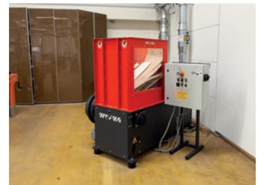
Der robuste Hacker kann in kleinen und mittelständischen Holzverarbeitenden Betrieben zur Zerkleinerung von Holzwerkstoffen aller Art, wie z.B. Resten von Spanplatten, MDF, Massivhölzern, bis hin zu extrem harten Hölzern eingesetzt werden. Die erzeugten Hackschnitzel eignen sich ideal zur anschließenden Brikettierung oder zur Lagerung im Spänebunker der Zentralheizung.
