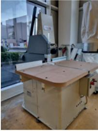
BJ 04, Pendelsäge mit manuellem Vorschub, schwenkbar 0° / + 45° / - 45°, 5,5 kW Motorstärke, 500 mm Sägeblatt-Ø, 30 mm Bohrung-Ø, 2800 U/min. Drehzahl, 510 mm (90°) / 350 mm (45°) Schnittlänge, 145 mm Schnitthöhe, Rollenbahn 500 mm breite, Anschlaglineal und Klappen 3.000 mm links / 3.500 mm rechts. Ausstellungsmaschine – vorführbereit. Preisstellung im überholten Zustand - 6 Monate Gewährleistung!
