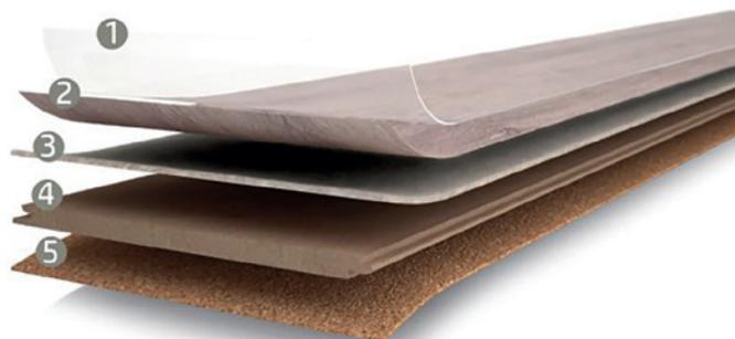
Der Fibrano® Naturboden ist in fünf durchdachten Schichten aufgebaut: Er besteht aus der HotCoating Beschichtung (1), dem lichtechten Digitaldruck (2), der Fibrano® Komfortschicht (3), der feuchtigkeitshemmenden Naturfaserplatte (4) und dem Presskork Gegenzug.
