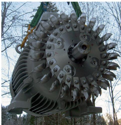
Nitrocarburiertes Peltonlaufrad aus Vergütungsstahl mit auswechselbaren Schaufeln, die form- und kraftschlüssig mit der Laufradnabe verbunden sind.
