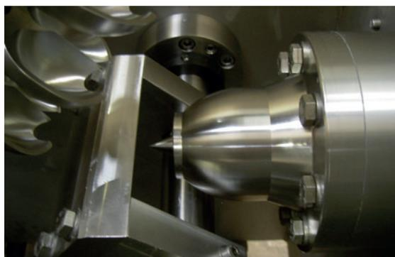
Düsenstock und Strahlableiter sind ein Teil des Innenlebens einer Turbine.
