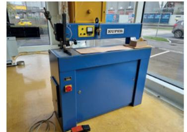
BJ 1985, 900 mm Ausladung, ca. 0,4 - 2 mm Furnierdicke, ca. 15m/min Vorschub, 0,18 kW Antriebsmotor, 0,5 kW Gesamtanschluss, LxBxH 1280 x 580 x 1470 mm, 166 kg. KEINE CE-Zertifizierung! Preisstellung im überholten Zustand - 6 Monate Gewährleistung.
