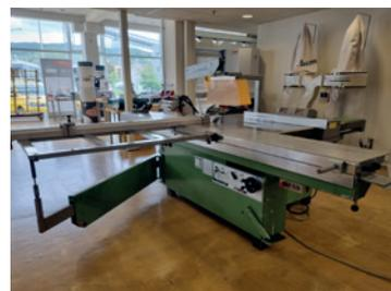
BJ 94, 5,5 kW Motorstärke, 0,75 kW Vorritzsäge, Schnitthöhe bei max. Sägeblatt-Ø: 450 mm (ohne Vorritzer) = 145 mm, 2800/4000/5500 U/min. Drehzahl, Vorritzer, 1.050 mm Schnittbreite, 3.300 mm Schnittlänge, Parallelanschlag: manuell/pneumatisch geklemmt - pneumatisch Absenkbare, Querschlitzen: Standard, Steuerung Schwenkung und Höhe mittels Fußpedal, Anzeige elektronisch, Preisstellung im überholten Zustand - 6 Monate Gewährleistung, KEINE CE Zertifizierung!
