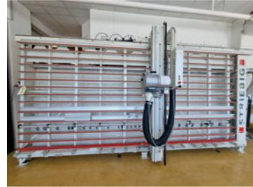
BJ 06, Alu-Lattenrost, 4300 x 2240 (2100 xHhor) x 80 mm Schnittbereich, 5,5 kW Sägemotorleistung, 300 mm Sägeblatt-Ø, 4750 U/min Sägeblatt-Drehzahl, 3x 400 V/50Hz Netzanschluss, LxHxT1xT2: 5620 x 2893 x 1695 mm. . Preisstellung im überholten Zustand - 6 Monate Gewährleistung.
