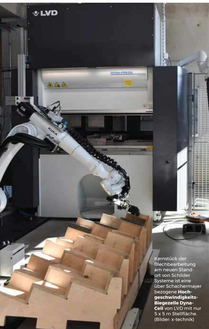
Kernstück der Blechbearbeitung am neuen Standort von Schilder Systeme ist eine über Schachermayer bezogene **Hochgeschwindigkeits-Biegezone Dyna-Cell** von LVD mit nur 5 x 5 m Stellfläche. (Bilder: x-technik)
