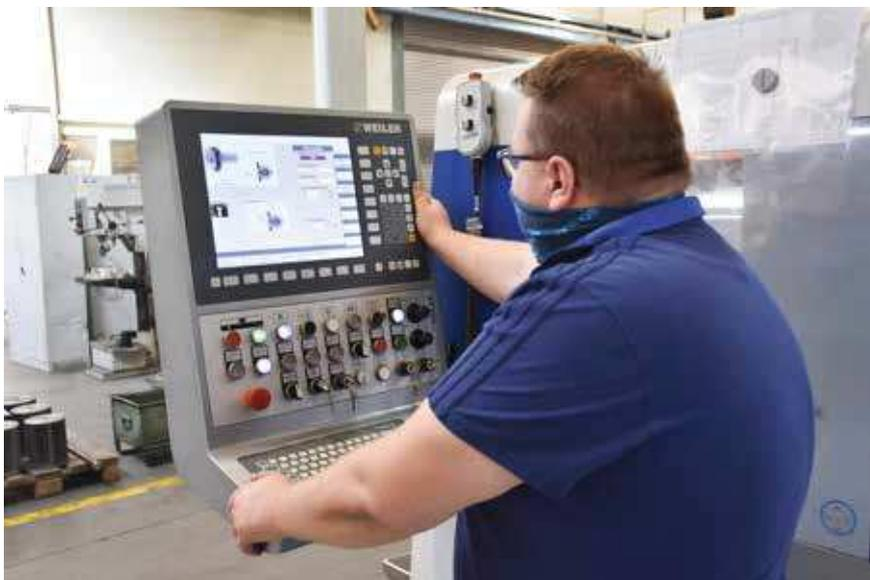
Die SL2-Steuerung von Weiler mit 15"-Monitor erlaubt das Abrufen vorgefertigter Bearbeitungszyklen und verleiht der Maschine **hohe Flexibilität bei geringstem Programmieraufwand.**
