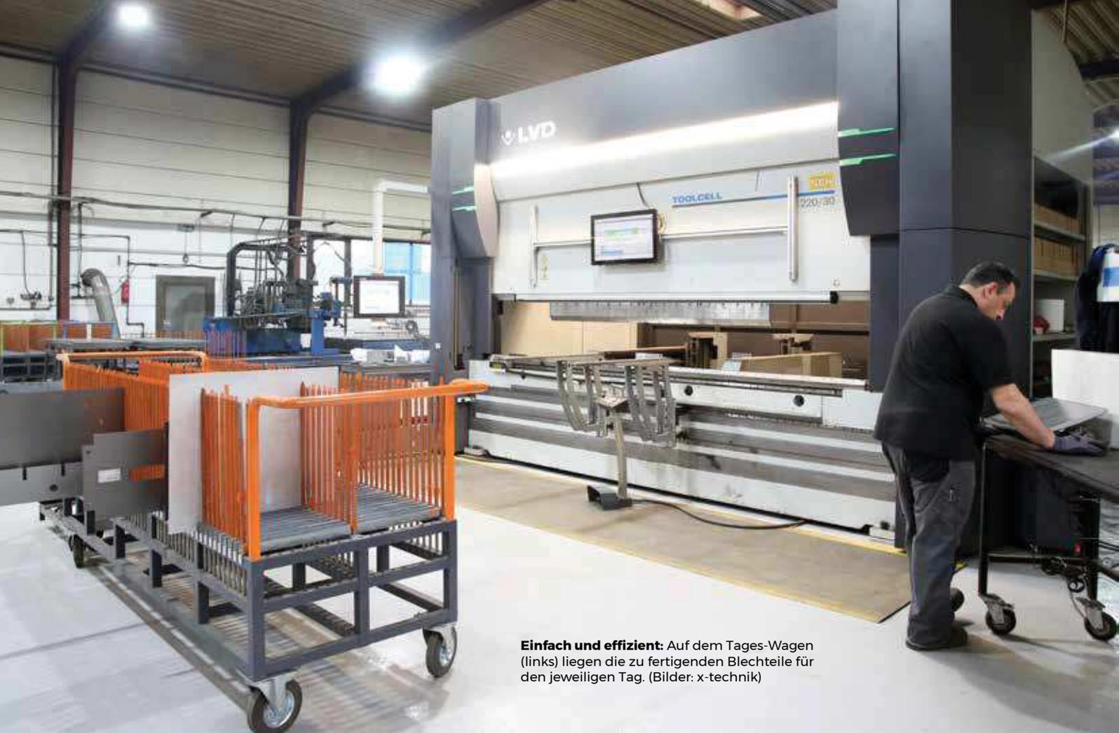
**Einfach und effizient:** Auf dem Tages-Wagen (links) liegen die zu fertigenden Blechteile für den jeweiligen Tag. (Bilder: x-technik)
