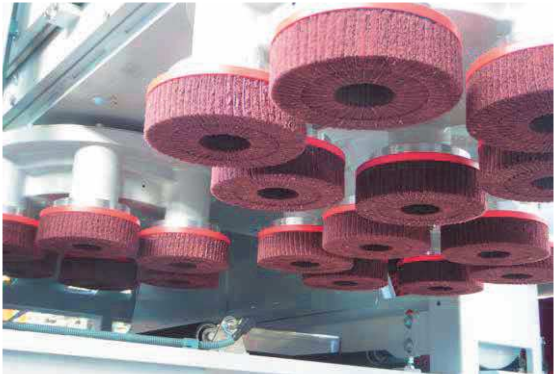
Um eine makellose Verrundung zu gewährleisten, setzt Weber den DR Planetenkopf ein. Die Bearbeitungsstation kann optional von oben und unten eingesetzt werden.
