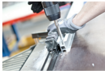
Bohrung der Profile
