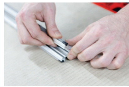
Vorbereitung der Profile zum Zusammenbau
